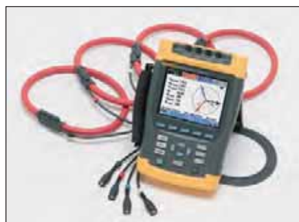
Fluke 435 con sondas flexibles
