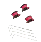
ES-162-P4 Conjunto pica/bobina para medidas de 4 hilos
